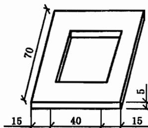
图1 粘接强度试件成型模框
